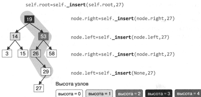
Рис. 6.11. Рекурсивные вызовы при добавлении элемента в дерево
