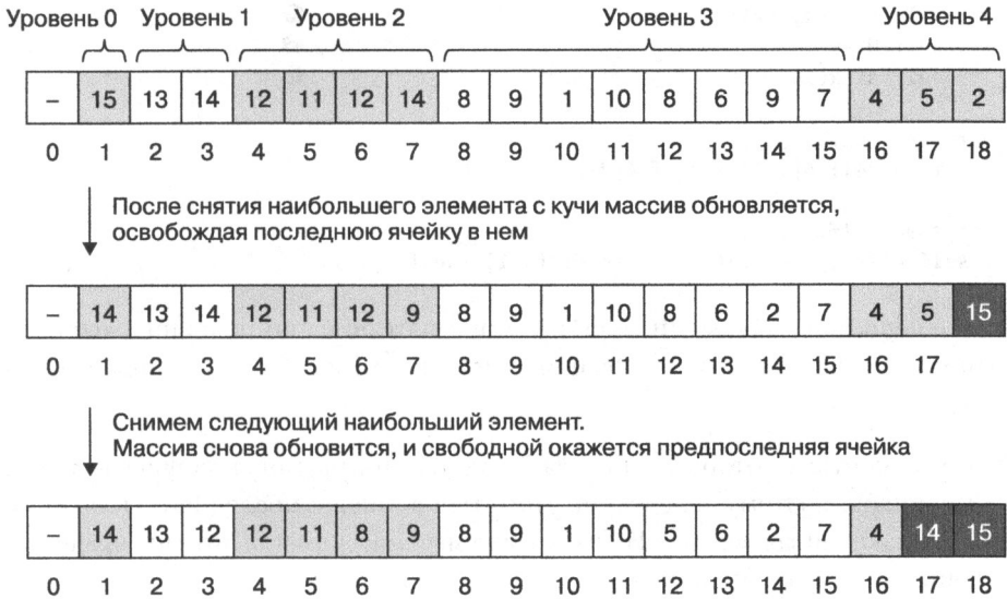
Рис. 5.13. Схема использования двоичной кучи с частичным убыванием для сортировки
