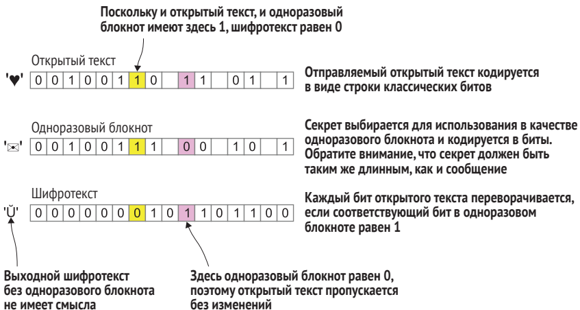
Рис. 3.8 Пример шифрования на основе одноразового блокнота, в котором для шифрования секретных сообщений используются случайные биты
