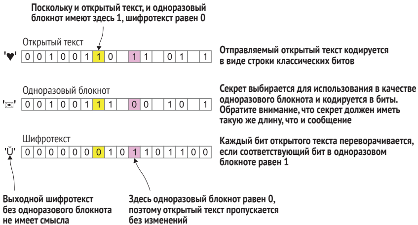
Рис. 2.17 Пример того, как использовать случайные биты для шифрования секретов, даже через интернет или другую ненадежную сеть. Здесь мы пытаемся безопасно отправить сообщение «♥». Если мы с Евой начнем с совместного секрета «☒», то мы сможем использовать его как одноразовый блокнот для защиты нашего сообщения
