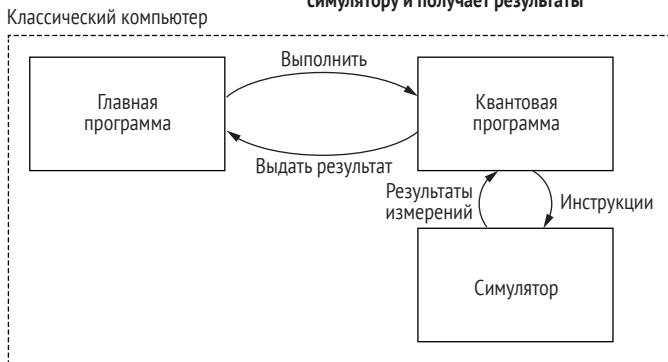
Рис. 2.1 Ментальная модель возможного использования квантового компьютера. Верхняя половина рисунка является общей моделью квантового компьютера. В этой книге мы будем использовать локальные симуляторы. Нижняя половина показывает то, что мы будем строить и использовать
