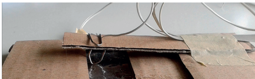
Рис. 10.13. Переключатель, считывающий перфокарту. Если он через отверстие касается фольги, электрическая цепь замыкается. Если нет, цепь остаётся разомкнутой
