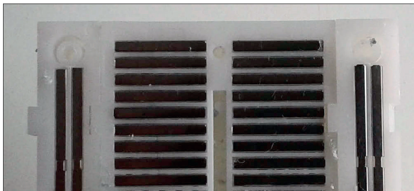
Рис. 8.6. Так выглядит макетная плата снизу, если снять защитное покрытие. На каждой половине платы каждый ряд контактных отверстий А, В, С, D, Е и F, G, H, I, J соединён проводником
