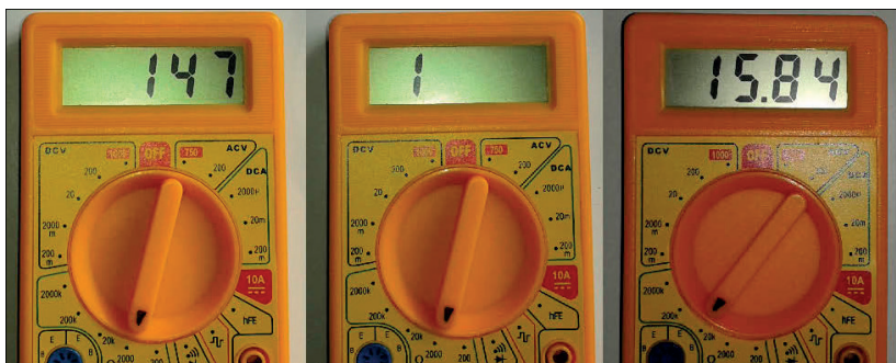
Рис. 8.3. Показания сопротивления: слева значение 147 Ом, в центре диапазон сопротивления превышен, а справа 15,84 кОм
