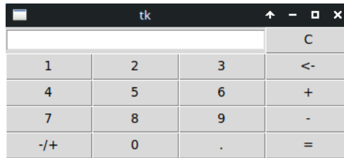
Рис. 11.4. Программа-калькулятор — первая работоспособная версия с кнопками сложения, вычитания и получения результата.
