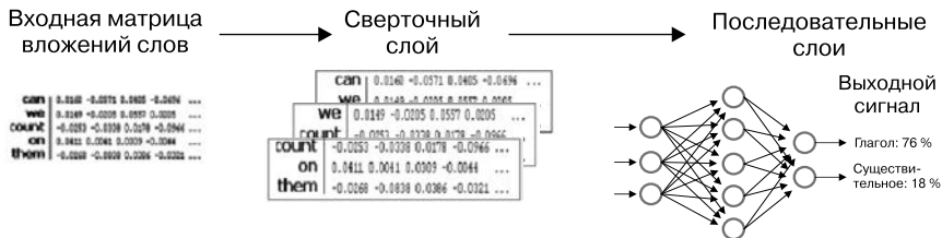
Рис. 1.7. Упрощенная схема применения сверточного подхода к задаче NLP
