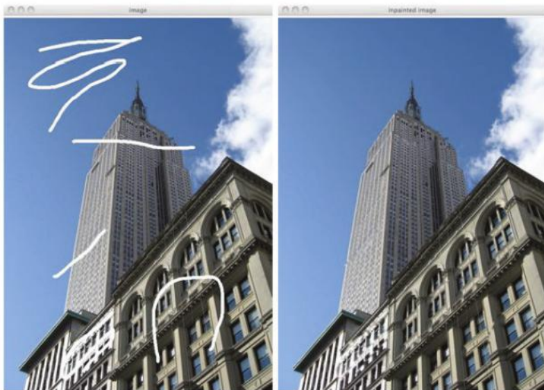
Рис. 10.8. Пример ретуширования с помощью OpenCV. На левом изображении пользователь пометил отдельные участки как «дефектные». На правом изображении показан результат после ретуширования
