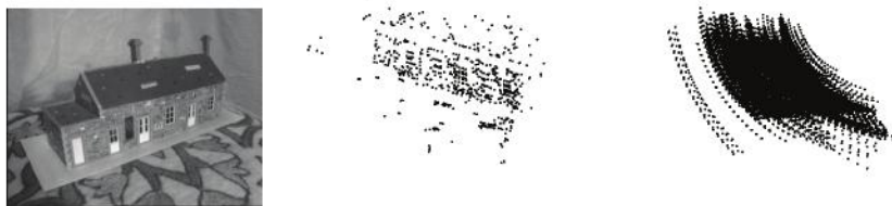
Рис. 4.2. Пример проецирования точек трехмерного пространства: исходное изображение (слева); проекции точек на плоскость (в центре); траектории проекций при повороте камеры (справа). Данные взяты из оксфордского набора «Модель дома»
