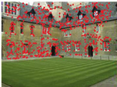
Рис. 5.6. Проекция точек на вид 1, вычисленные с помощью оценки матрицы камеры
