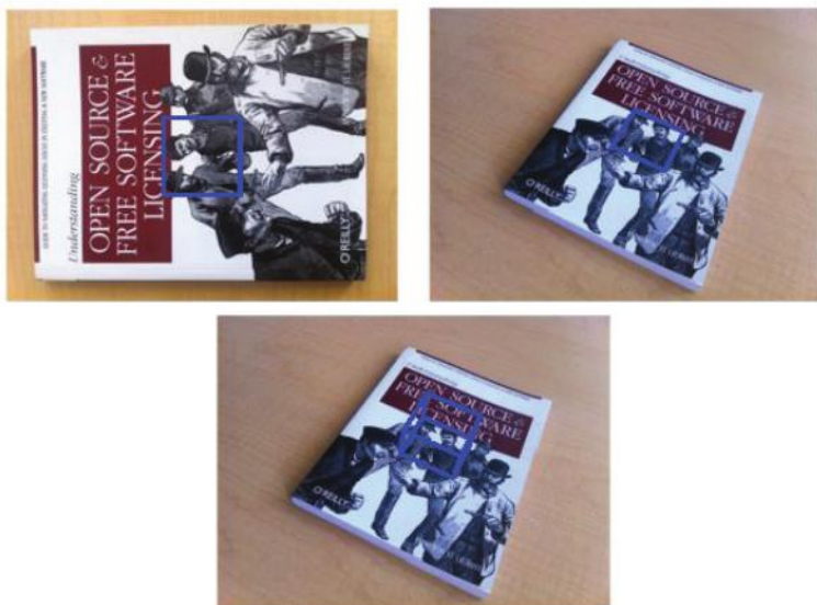
Рис. 4.4. Пример вычисления проекционной матрицы для нового ракурса с использованием плоскостного объекта в качестве маркера. Сочетание признаков изображения с совмещенным маркером дает гомографию, которую можно использовать для вычисления положения камеры. Эталонное изображение с серым квадратом (слева сверху); фотография, снятая из неизвестной точки, с тем же квадратом, преобразованным в соответствии с вычисленной гомографией (справа сверху); куб, преобразованный с использованием вычисленной матрицы камеры (внизу)
