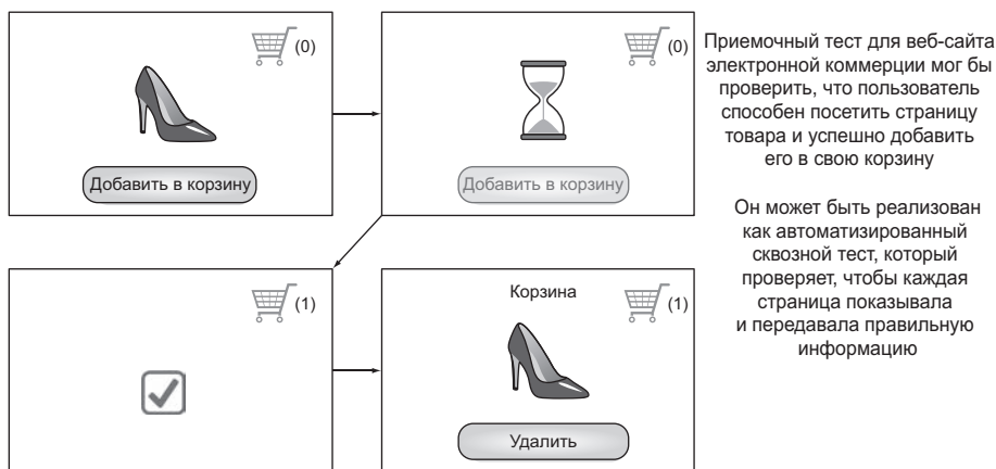
Рис. 5.2. Приемочные тесты проверяют рабочие потоки с точки зрения пользователя
