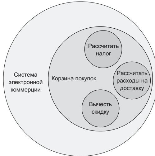
Рис. 3.5. Разложив систему на малые части, вы можете инкапсулировать формы поведения и данные в изолированные фрагменты. Инкапсуляция побуждает вас уменьшать ответственность любой заданной части кода во избежание сложных зависимостей
