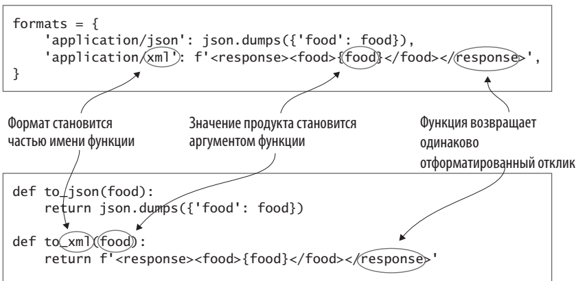
Рис. 9.3. Извлечение внутрискриптовых выражений в качестве функций
