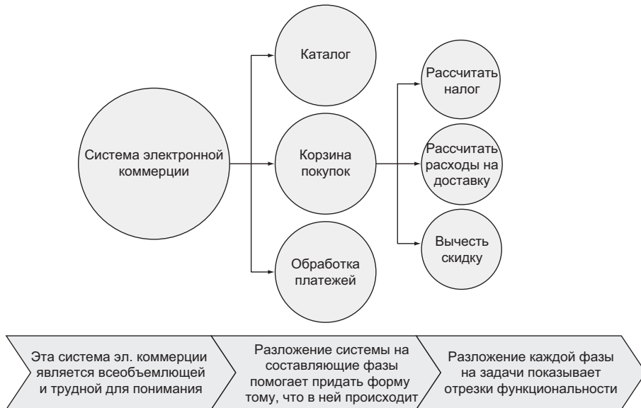
Рис. 3.4. Разложение на гранулярные компоненты облегчает понимание
