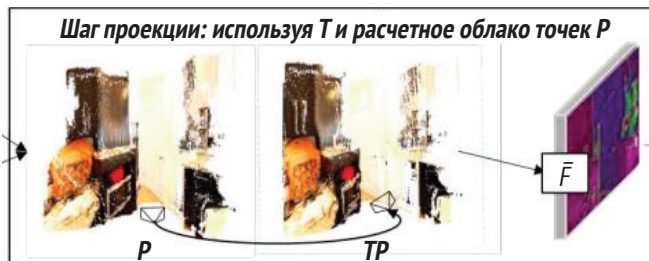
Рис. 9.4 ❖ Трансформация позы в нейронном отрисовщике облака точек
