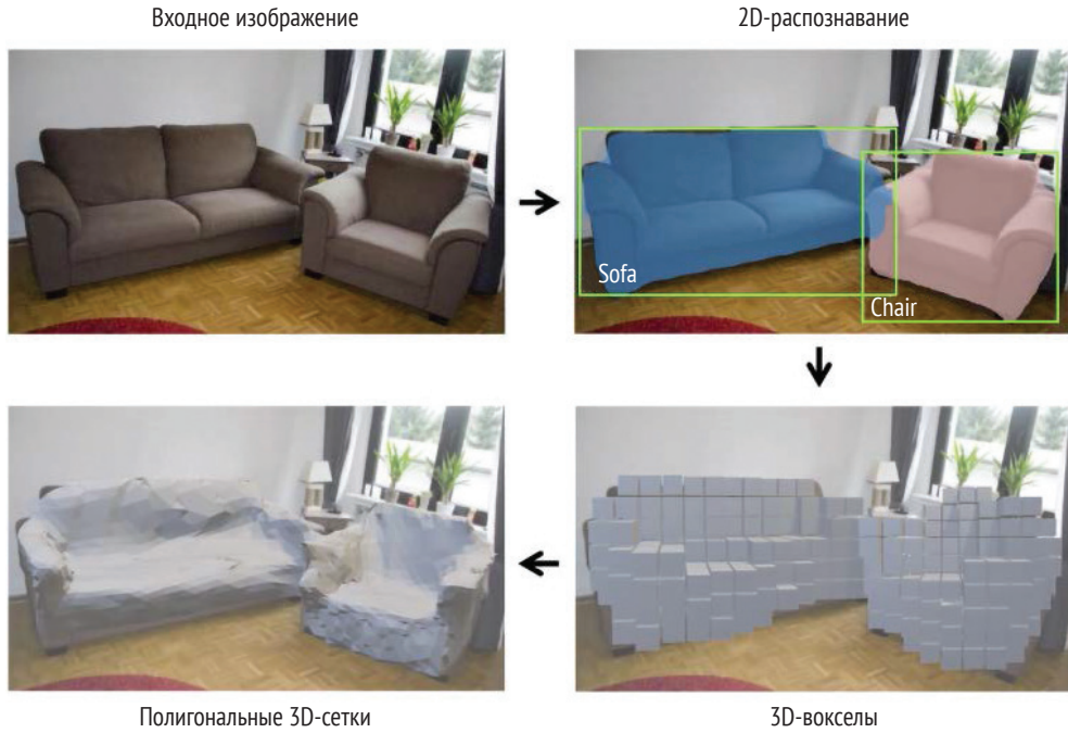
Рис. 10.4 ❖ Общая структура модели Mesh R-CNN
