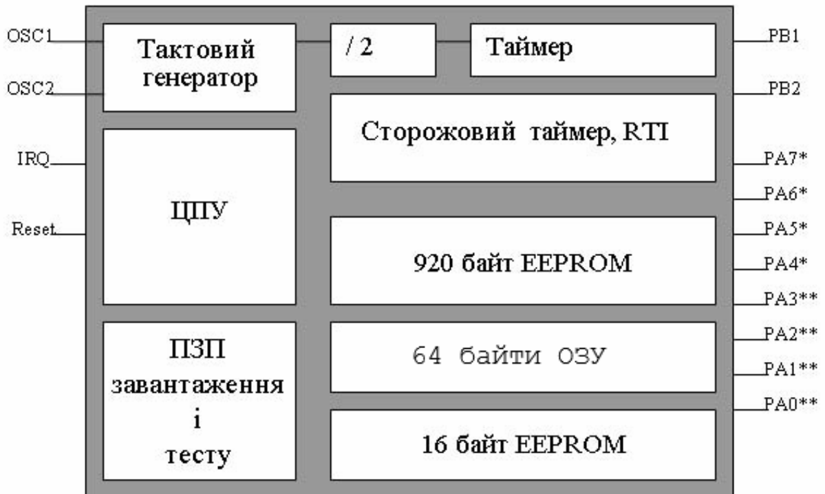
Рисунок 2.15 – Блок-схема мікроконтролера MC68HC805K3
