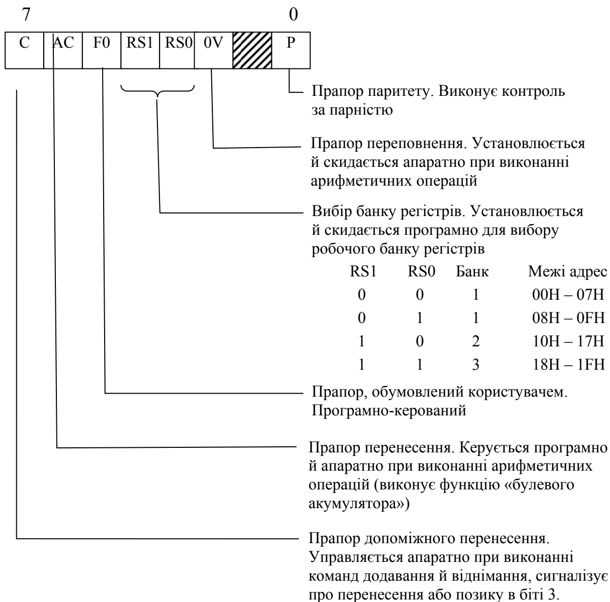
Рисунок 2.5 – Призначення бітів регістру слова стану програми (ССП)
