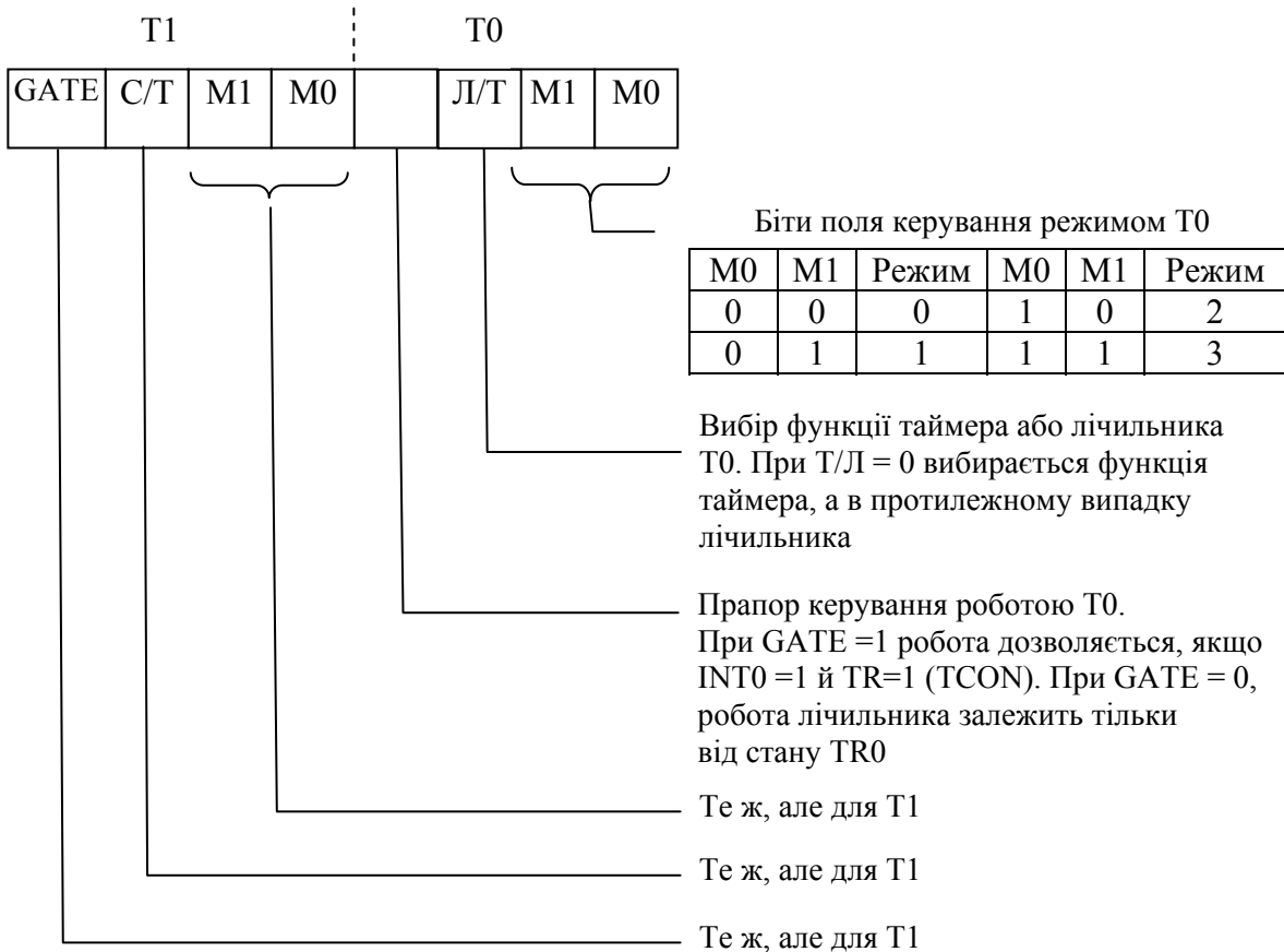
Рисунок 2.7 – Призначення бітів регістра режиму роботи таймера / лічильника (PPTL)
