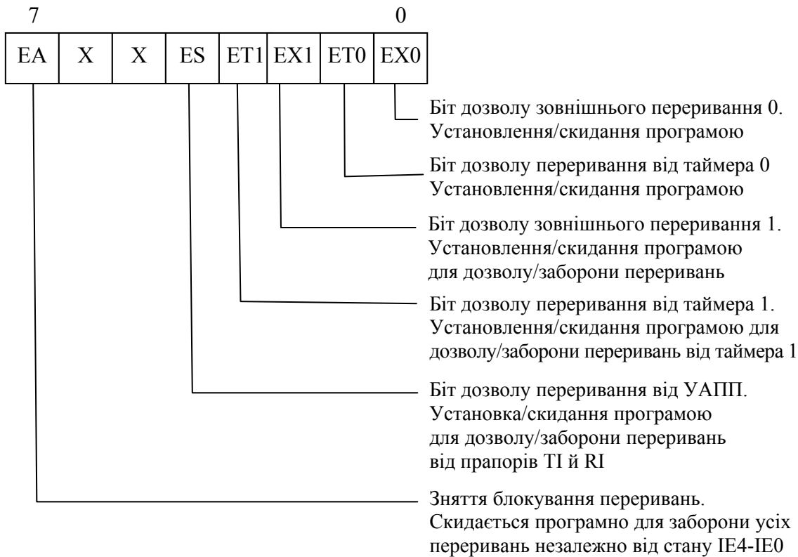
Рисунок 2.10 – Призначення бітів регістру дозволу переривань (IE)
