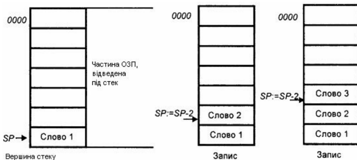
Рисунок 5.5 – Принцип роботи апаратно-програмного стека
