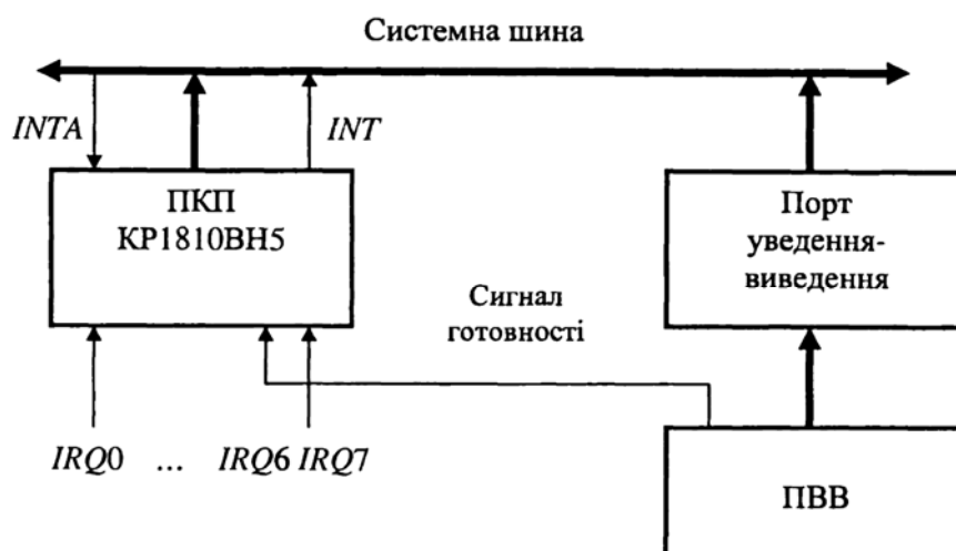
Рисунок 6.2 – Схема обміну за перериванням
