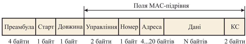
Рис. 2.56. Структура фрейму даних у сімействі стандартів IEEE 802.15.4
