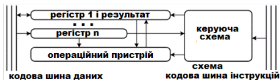
Рис. 2.9. Структура арифметико-логічного пристрою
