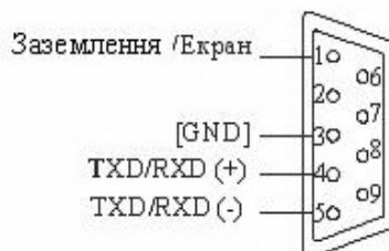
Рис. 2.31. Розлінування контактів RS-485 для розетки рознімача DB-9
