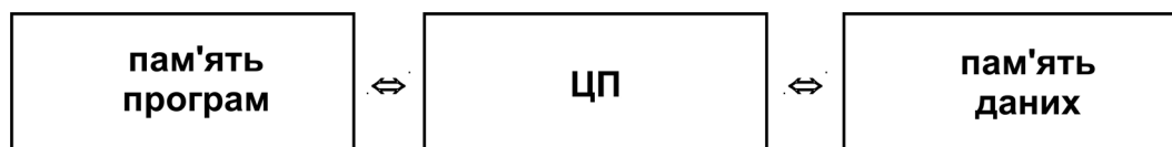
Рис. 1.5. Гарвардський тип роботи з пам'яттю
