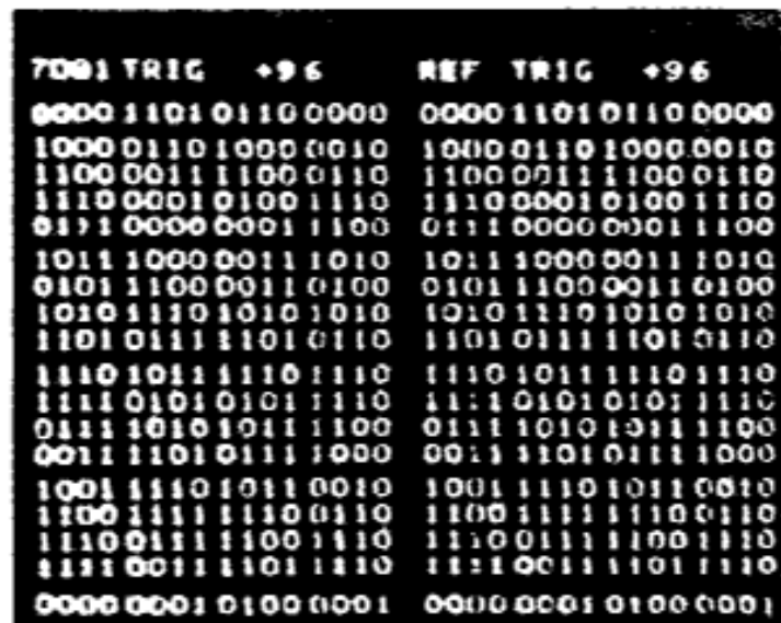
Рис. 14.16. Пример отображения логического состояния на дисплее логического анализатора. (С разрешения фирмы Tektronix.)
