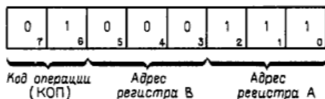
Рис. 6.1. Команда пересылки содержимого регистра А в регистр В, в которой использована неявная адресация. Код операции равен 01, адрес регистра А = 111, адрес регистра В = 000.
