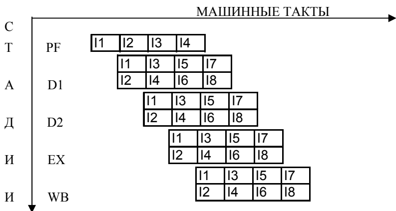
Рис. 6.9. Поток команд через конвейер Pentium
