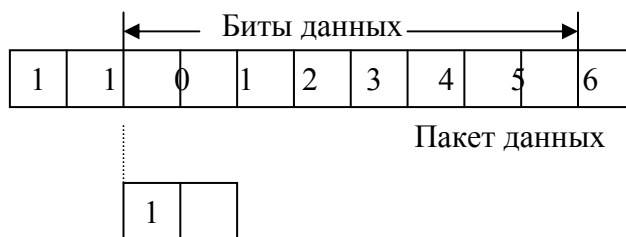
Рис. 6.4. Формат сообщения при последовательной передаче
