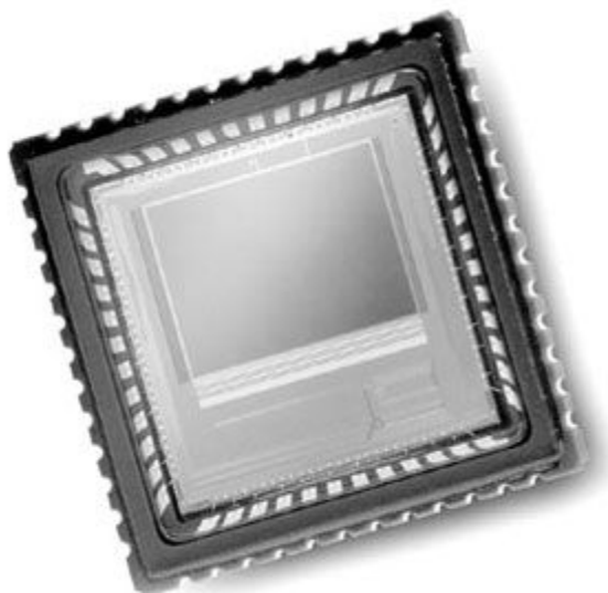
рис. 3.1. Матрица размером 1/1,8" с разрешением 4,5 мегапиксела
