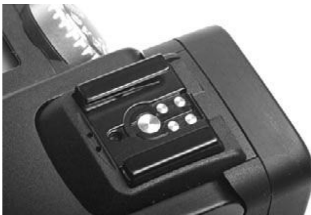
Рис. 5.20. «Горячий башмак» – контакты для подключения внешней вспышки
