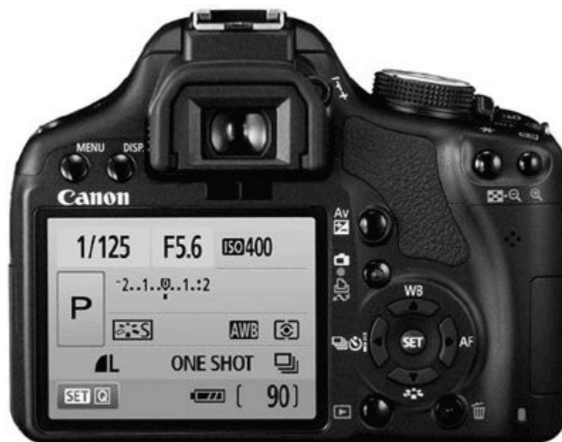
Рис. 1.1. Управляющие элементы камеры Canon EOS 450D
