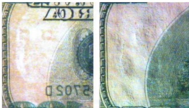
Рис. 86 Імітація водяного знаку механічним вискоблюванням (ліворуч - при спостереженні на просвіт, праворуч - в освітленні під нахилом)
