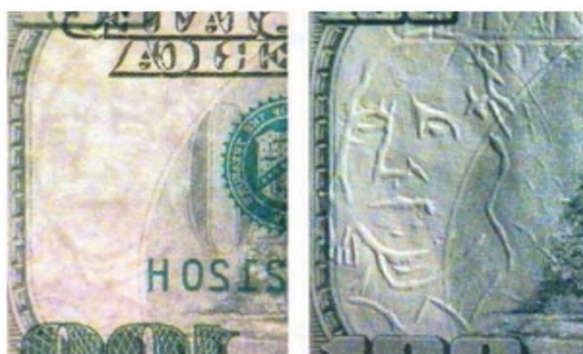
Рис. 85 Водяні знаки, імітовані тисненням(ліворуч- при спостереженні на просвіт, праворуч – в освітленні під нахилом)
