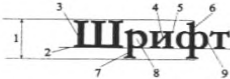
Рис. 80 Основні елементи шрифту: 1-кегель; 2-лінія шрифту; 3-основний штрих; 4-сполучний штрих; 5-зарубка; 6-верхній виносний елемент; 7- нижній виносний елемент; 8-внутрішньолітерний просвіт; 9-наплив
