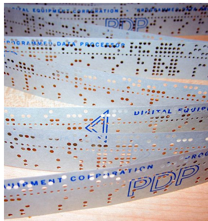
Рис. 3.3. Перфострічка, яка використовувалася у PDP-11
