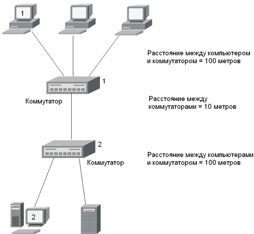
Рис. 22.11. Схема простой, но "длинной" сети
