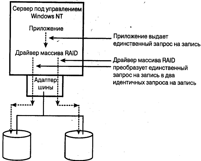
Рис. 9.16. Зеркальное отражение на уровне программного массива RAID
