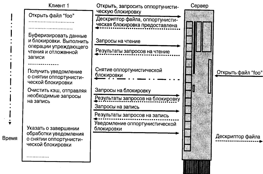
Рис. 3.3. Последовательность операций при эксклюзивной оппортунистической блокировке
