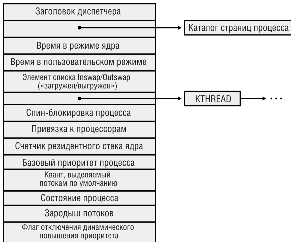
Рис. 6-3. Блок процесса исполнительной системы
