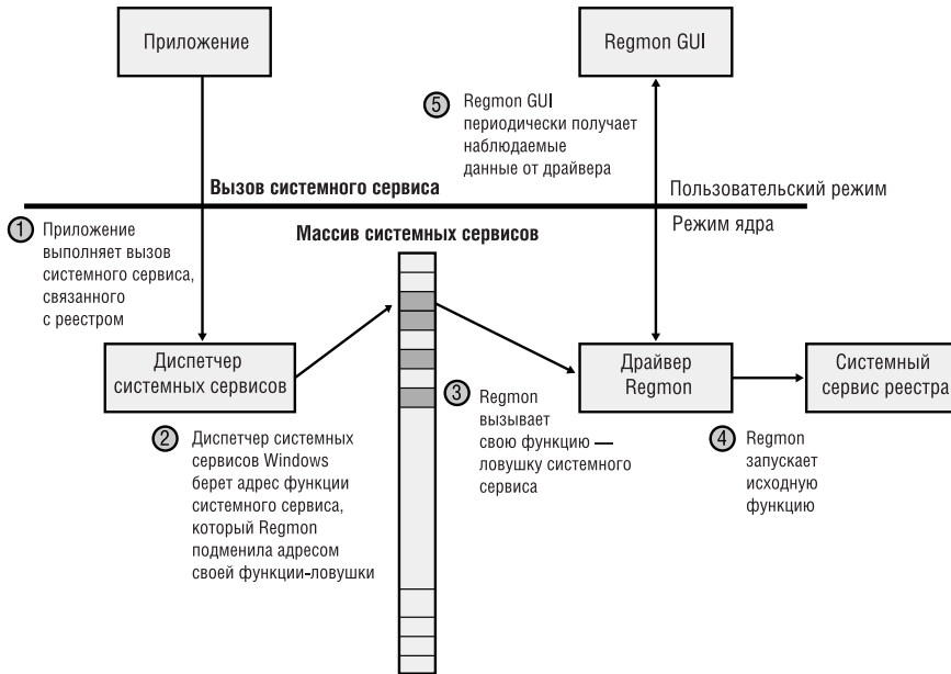
Рис. 4-3. Так Regmon использует перехват системных сервисов
