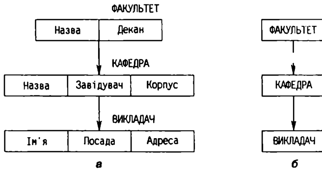
Рис. 2.1. Графічне зображення схеми ієрархічної структури даних: з уточненнями (а); без уточнень (б)
