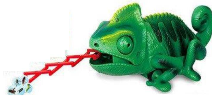
Рис. 8.7. Захват, принцип дії якого запозичений з язика хамелеона
