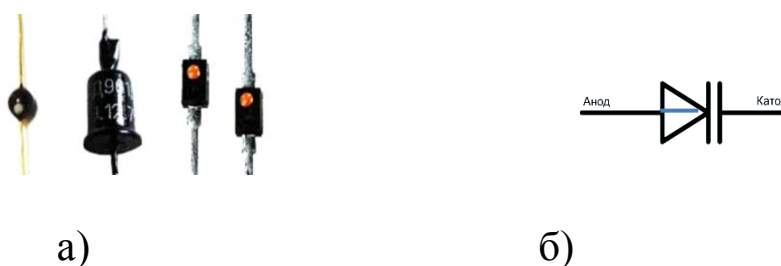
Рис. 5.15. Умовне зображення варикапу (а) та зовнішній вигляд (б) деяких його типів
