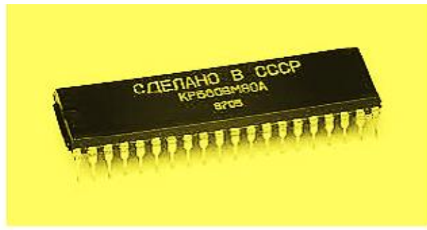
Рис. 7.2. Зовнішній вид 8-розрядного однокристального мікропроцесора Intel 8008 і КР580ВМ80А
