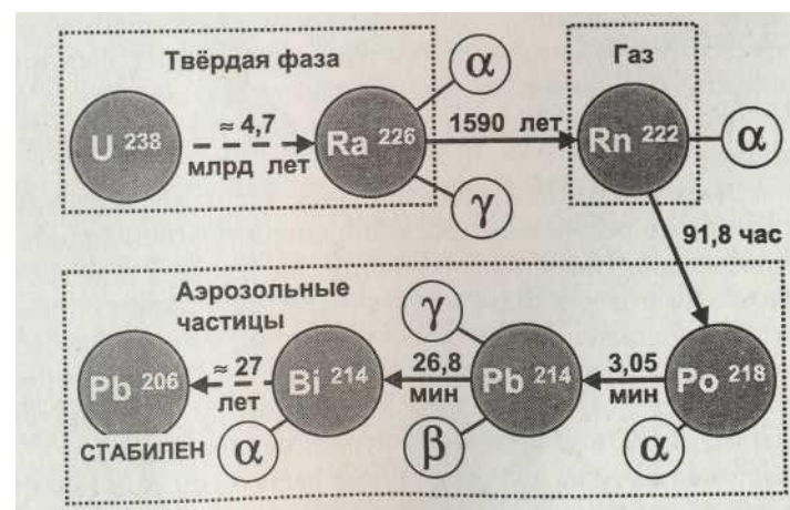
Рис. 4.14. Схема части радиоактивного семейства урана-238, содержащей радон-222 и продукты его распада. Указаны типы распада и периоды полураспада (сплошные стрелки). Штриховые стрелки означают достаточно длинные ряды превращений, и на них указаны максимальные периоды полураспада в ряду. Выделившийся в виде газа радон попадает в воздух, где химически активные металлы - продукты его распада (полоний, висмут и свинец) почти мгновенно оседают на аэрозольных частицах
