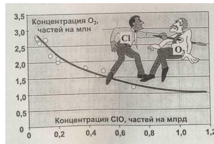
Рис. 4.18. Зависимость концентрации озона от концентрации монооксида хлора, построенная по данным высотных самолётных измерений над Антарктидой, полученным 16 сентября 1987 г. Кругами отмечены экспериментальные точки, по которым построена зависимость
