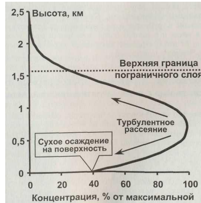
Рис. 4.4. Типичная зависимость концентрации атмосферной примеси от высоты на большом расстоянии от источника
