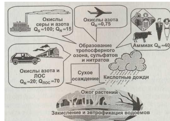
Рис. 4.6. Схема антропогенного закисления природной среды. Оценки глобальной антропогенной эмиссии соединений серы Q_S и азота Q_N приводятся в миллионах тонн самих этих элементов, так как при эмиссии они могут входить в состав различных веществ. Эмиссия летучих органических соединений ЛОС Q_{ЛОС} дана в миллионах тонн
