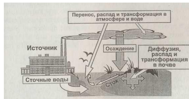
Рис. 4.1. Загрязняющее вещество после эмиссии из источника переносится в воздухе и воде, одновременно подвергаясь химическим превращениям. Из атмосферы оно может осаждаться вследствие захвата поверхностью (сухое поверхностное осаждение), гравитационного оседания и вымывания осадками
