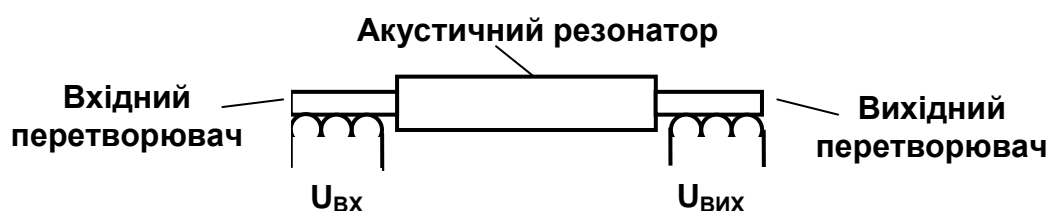
Рис. 4.10. Елементи магнітострикційного перетворювача
