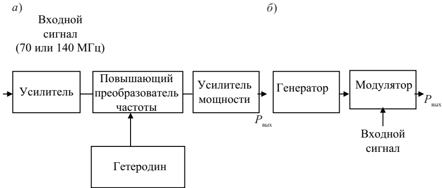
Рис. 5.17. Схема передатчика: a – усилительная; б – генераторная
