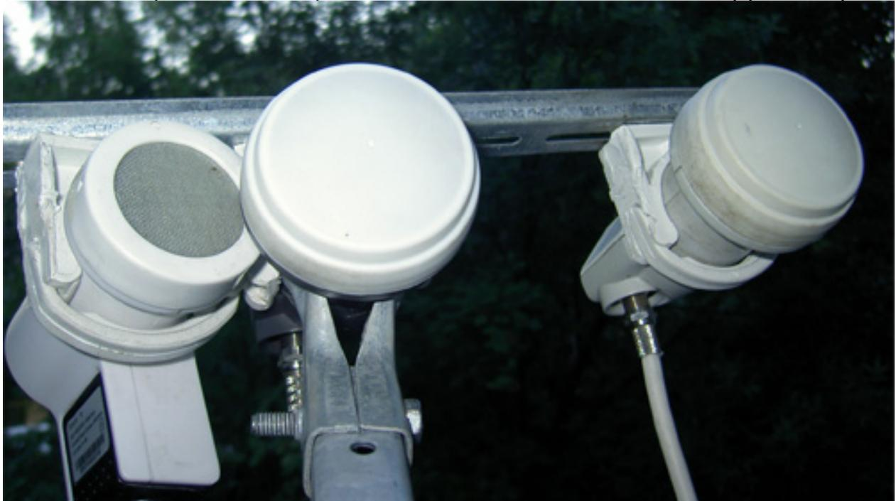
**Мультифид на три спутника. (36E (НТВ+) 40E(focus) 53E (рыбалка) )**
