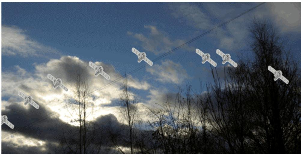
Этот рисунок примерно показывает расположение спутников на небе. Как видно, спутники располагаются по дуге, но необязательно на одинаковом расстоянии друг от друга.
