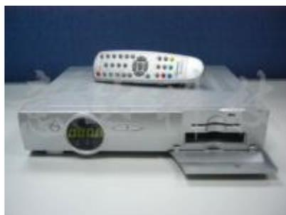
Ресивер с специальным модулем (вверху справа) и CI интерфейсом (внизу, справа)
