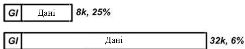
Рисунок 3.13 — Порівняльна оцінка частки захисного інтервалу GI в загальній тривалості символу для режимів 8k і 32k
