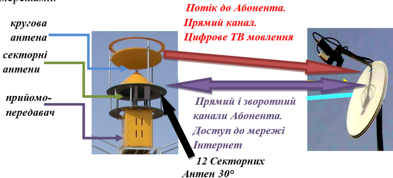
Рисунок 8.31 — Обладнання системи UMDS
