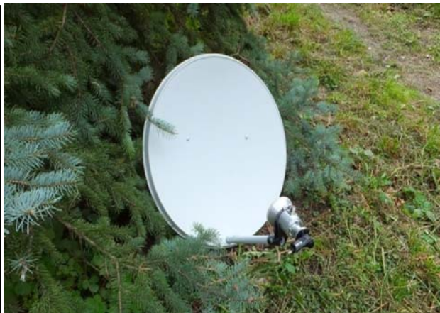
Рисунок 8.51 — Приймально-передавальна антена АС в зборі
