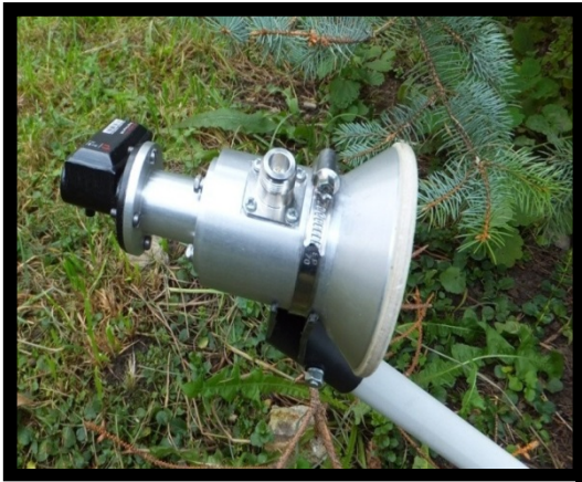
Рисунок 8.50 — Розташування приймального конвертера відносно дводіапазонного селектора поляризації
