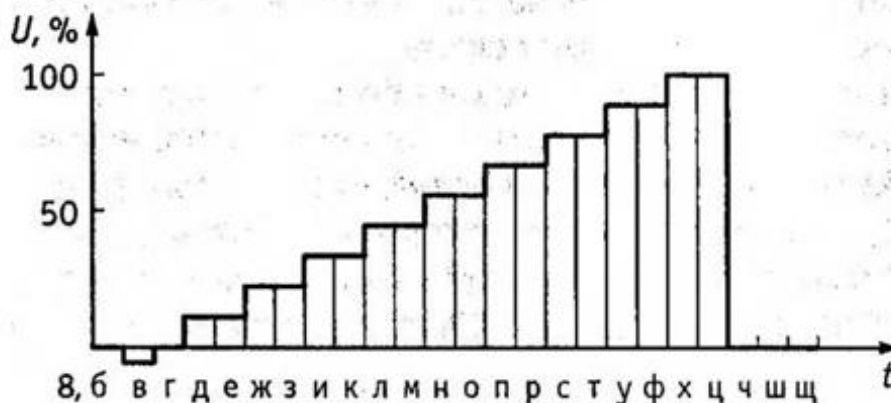
Мал. 17. Осцилограма ступеневої телевізійного сигналу, відповідної ділянці 8 б-щ уэит
