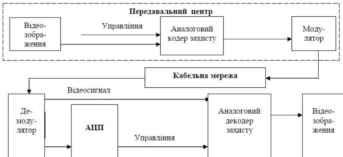
Рис. 2. Структурна схема цифро-аналогового методу закриття відеосигналу
