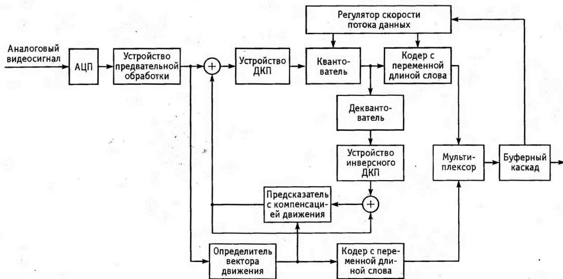
Рис. 10. Функціональна схема пристрою кодування з інформаційним стисненням по стандарту mpeg-2
