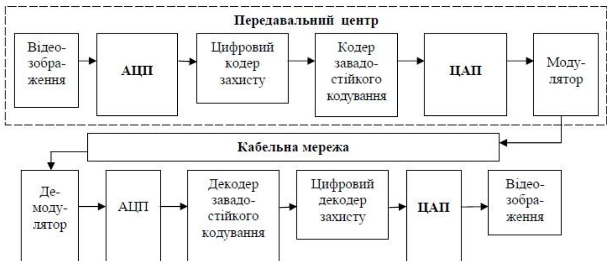
Рис. 3. Структурна схема цифрового методу закриття відеосигналу
