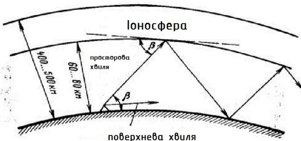
Рис.1.1.розповсюдження просторової та поверхневої хвиль
