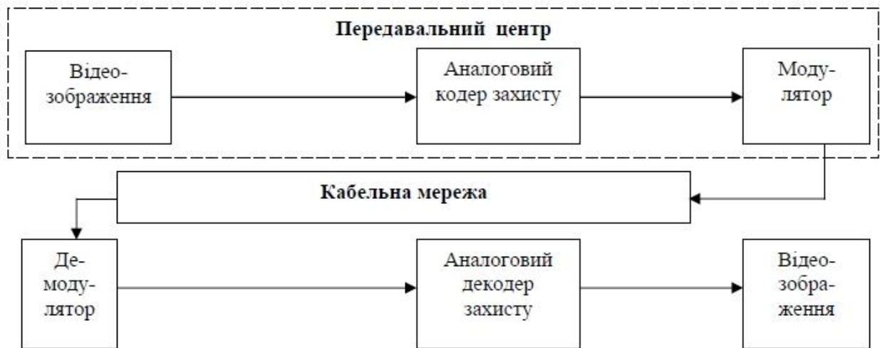
Рис. 1. Структурна схема аналогового методу закриття відеосигналу
