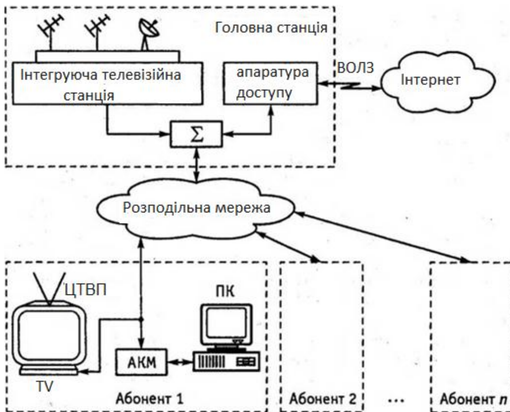
мал.15.функціональна схема цифрової мультисервісної мережі кабельного телебачення інтерактивного типу. X - суматор; цтвп - цифрова телевізійна приставка dvb-c
