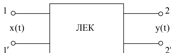
Рисунок 1.37 – Зображення ЛЕК у вигляді чотиріполюсника
