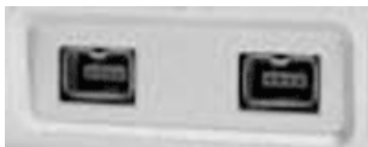
Рис. 1.24. Порт IEEE1394 4-контактный
