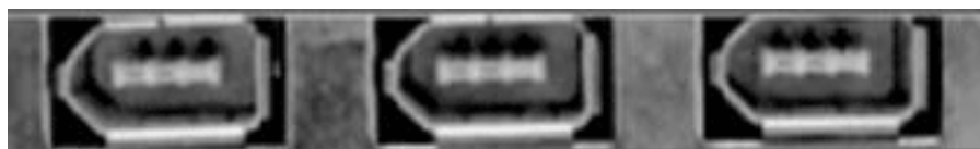
Рис. 1.25. Порт IEEE1394 6-контактный
