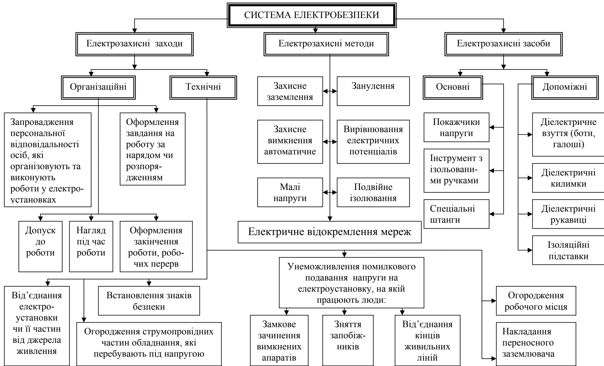
Рис. 4.5. Блок-схема системи електробезпеки
