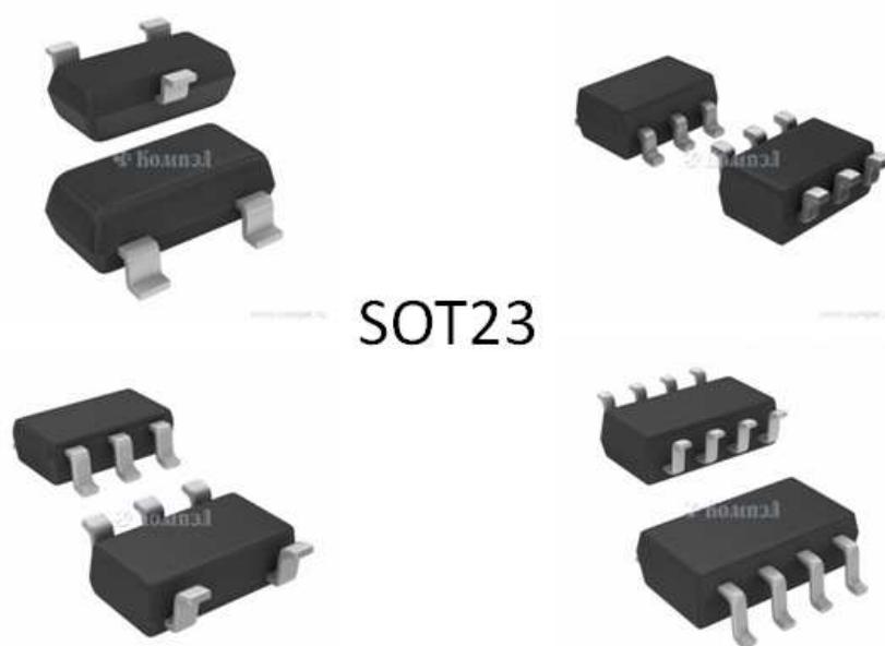
Рис. 7. Разновидности корпуса типа SOT23
