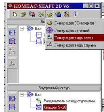
Рис. 18. Создание вида слева и твердотельной модели детали
