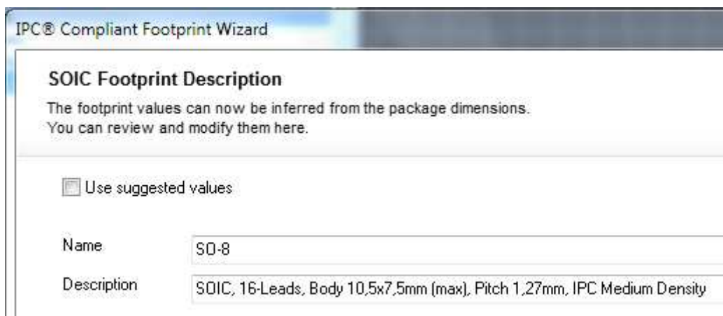
Рис. 95. Описание посадочного места под корпус SO-8
