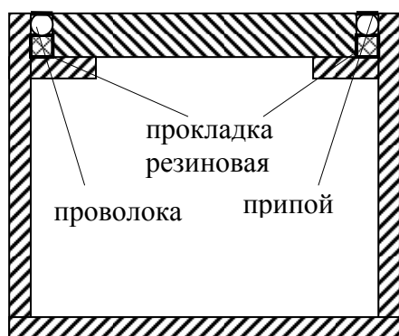
Рис. 9.6. Паяное разборное герметичное соединение
