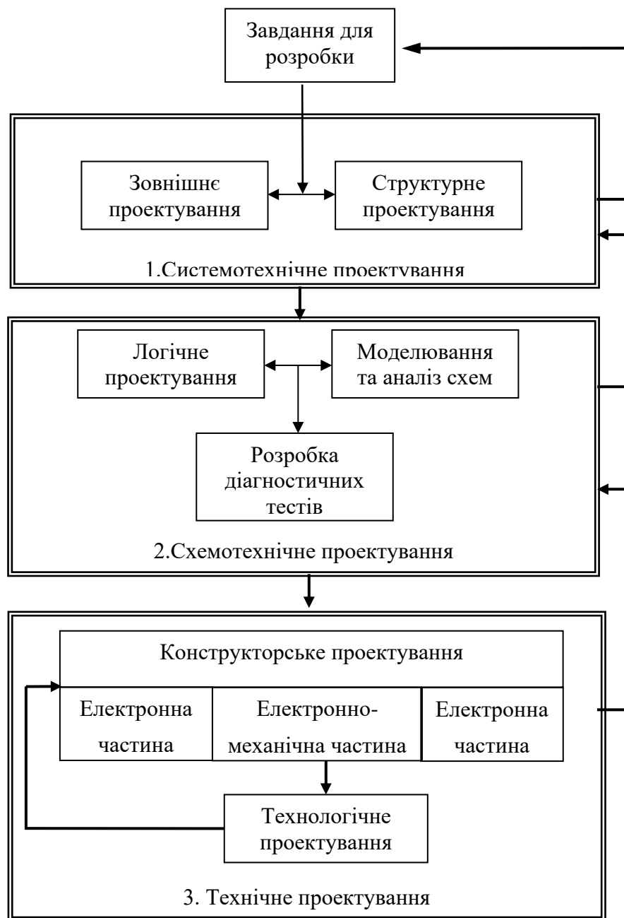
Рис.1. Етапи процесу проектування РЕЗ.
