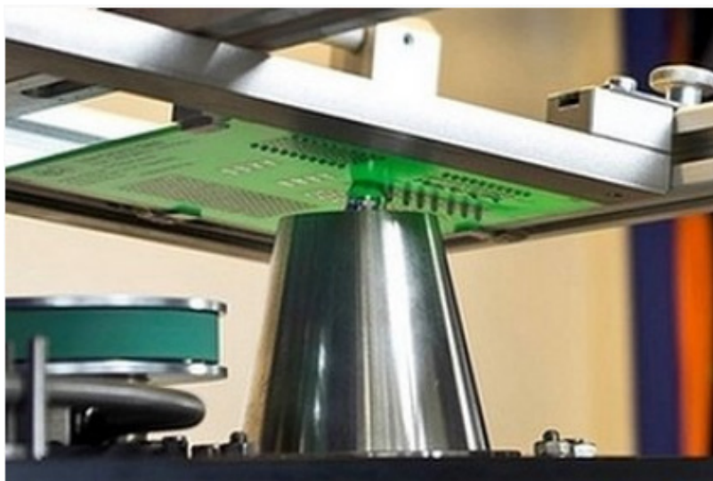
Рисунок 3.10 – Селективне паяння за допомогою сопла
