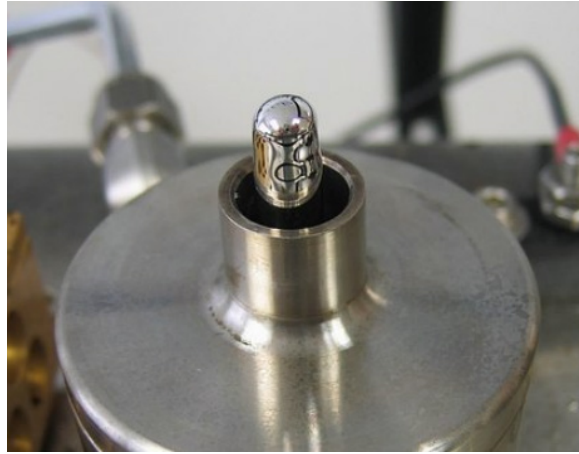
Рисунок 3.11 – Сопло для селективного паяння мініхвилею
