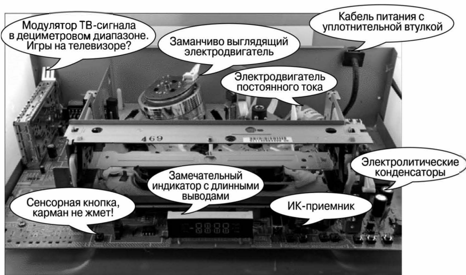
Рис. 10.6. Старый видеомаягнитофон — это кладезь полезных радиодеталей для опытного старьевщика
