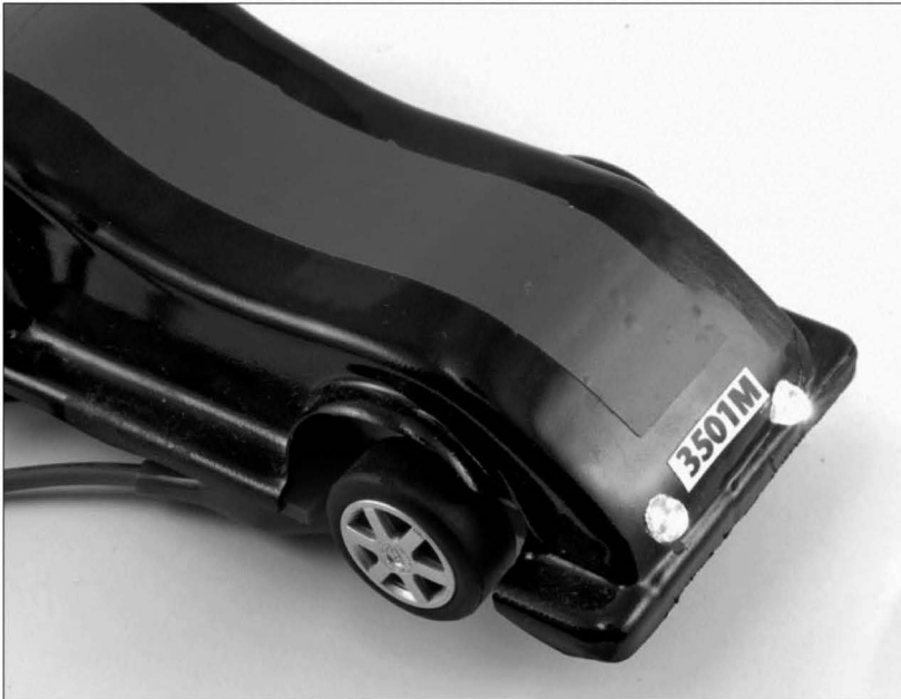
Рис. 4.31. Модернизированный игрушечный гоночный автомобиль
