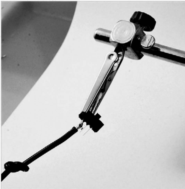
Рис. 1.15. Подсоединение выключателя к положительному выводу
