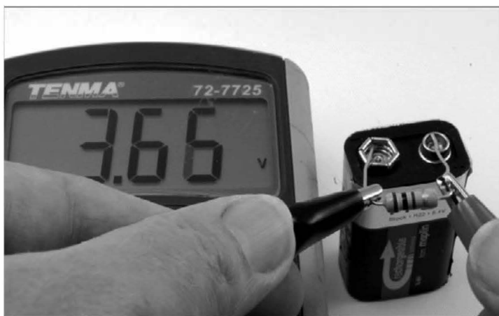
Рис. 10.4. Проверка работоспособности батареи с помощью резистора и мультиметра
