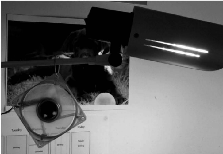
Рис. 1.10. Отвод едкого дыма от рабочего места
