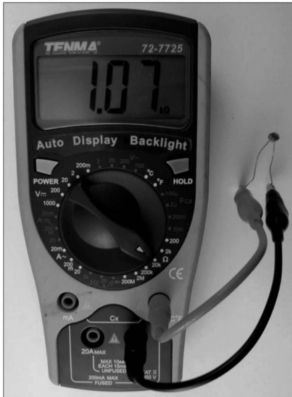
Рис. 3.8. Измерение сопротивления фоторезистора
