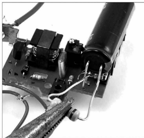
Рис. 10.1. Безопасная разрядка конденсатора
