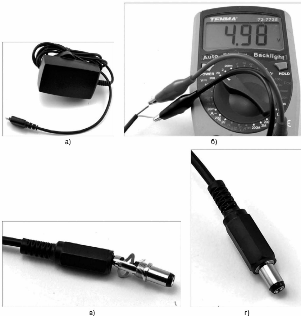
Рис. 10.7. Замена разъема на кабеле зарядного устройства
