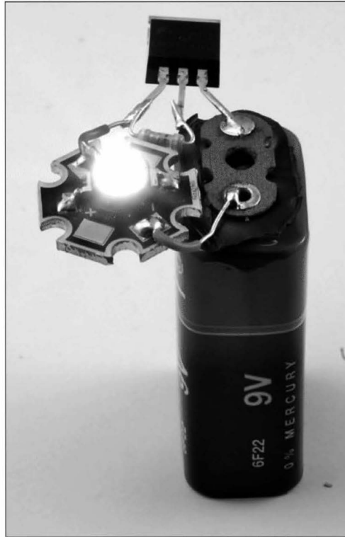
Рис. 4.13. Компактное устройство аварийного освещения помещения
