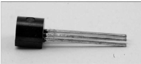
Рис. 8.12. Температурный датчик TMP36
