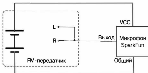
Рис. 9.10. Электрическая схема подслушивающего устройства
