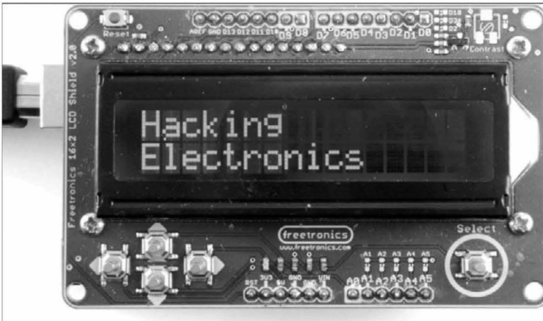
Рис. 6.28. Модуль с жидкокристаллическим алфавитно-цифровым дисплеем
