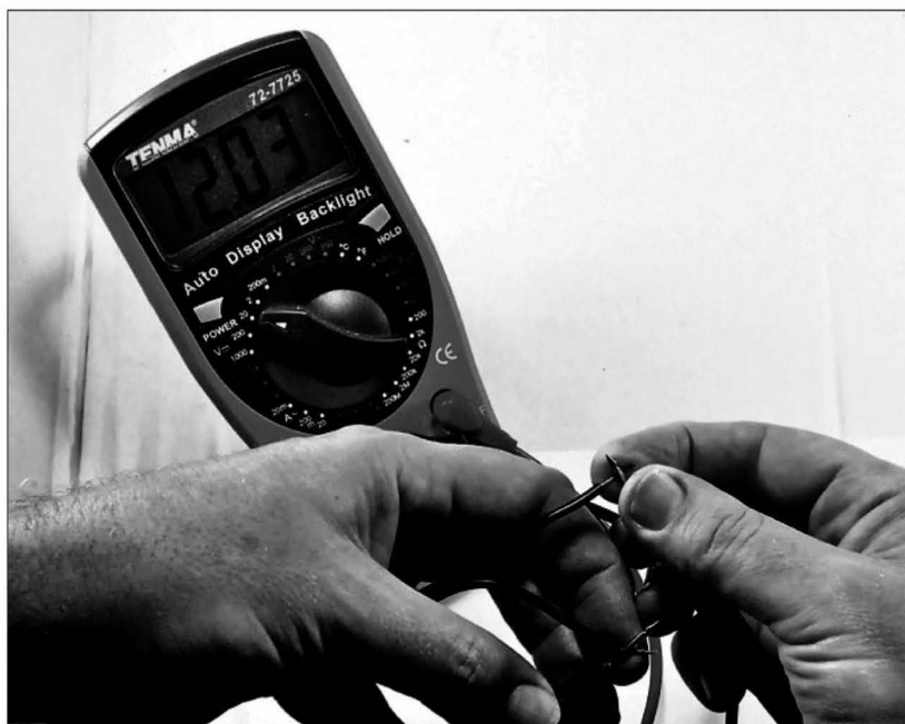
Рис. 1.13. Определение полярности источника питания с помощью мультиметра
