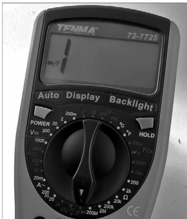
Рис. 1.8. Проверка мультиметром целостности (неразрывности) цепи
