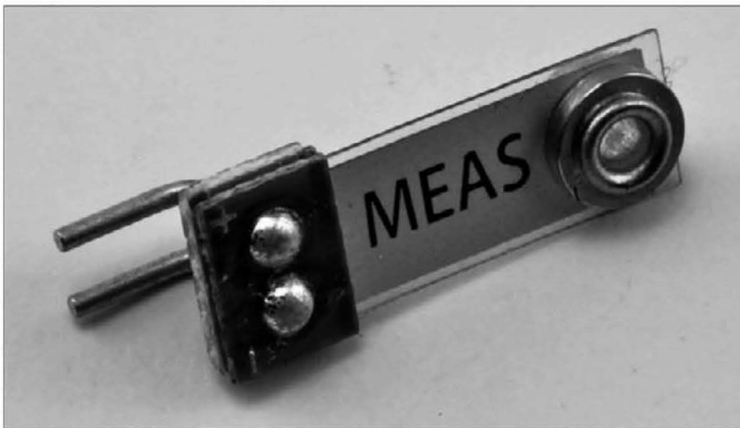
Рис. 8.10. Пьезоэлектрический датчик вибрации
