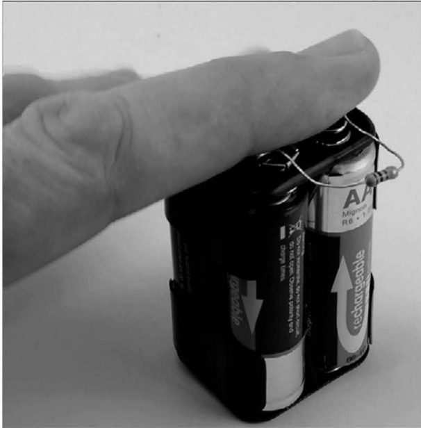
Рис. 3.3. Устройство нагрева резистора
