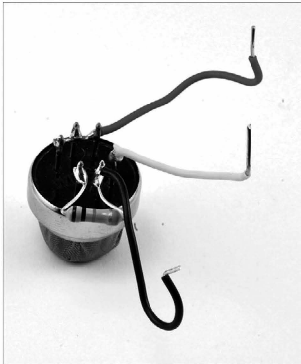
Рис. 8.3. Удлинение выводов датчика проводами
