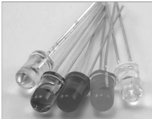
Рис. 2.6. Простые светодиоды разных цветов
