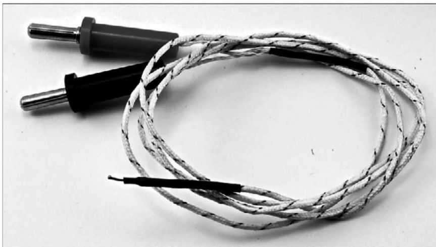
Рис. 11.3. Температура чаще всего измеряется термопарой
