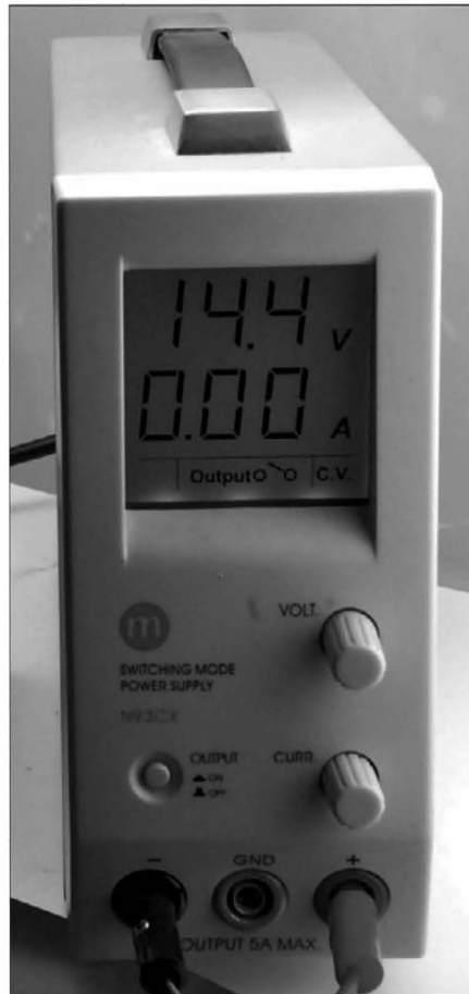
Рис. 11.7. Источник питания с плавно регулируемыми выходными параметрами
