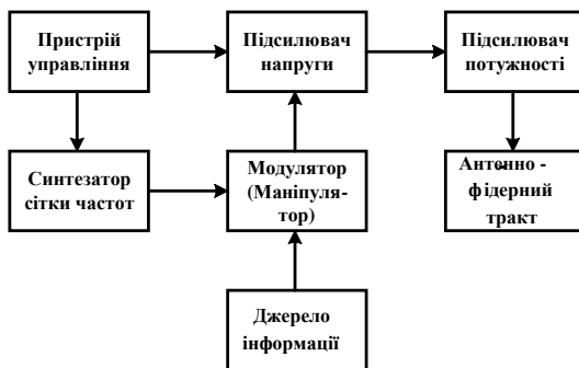
Рис. 2.1. Структурна схема типового радіопередавача
