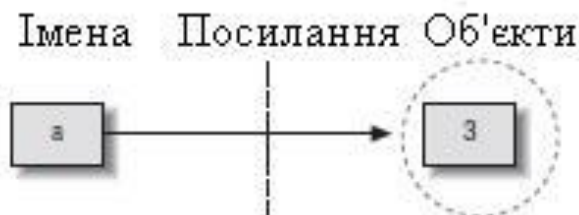
Рис. 4.1. Імена та об'єкти після виконання операції присвоєння a = 3 . Змінна перетворюється на посилання на об'єкт «3», у внутрішньому поданні змінна є вказівником на простір пам'яті з об'єктом, створеним в результаті інтерпретації літерального виразу «3»
