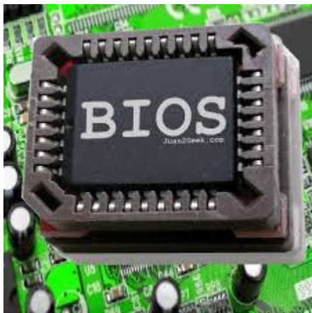
Рис. 1.16. Фізичне розміщення та інтерфейс BIOS
