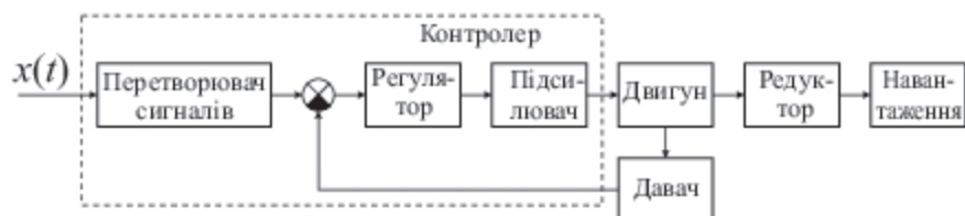
Рис. 9.7. Сервопривід як система автоматичного регулювання
