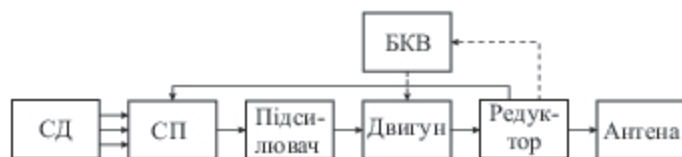
Рис. 9.4. Структура пристрою обертання антени
