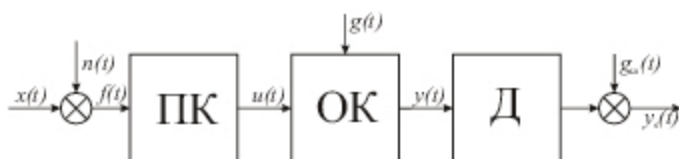
Рис. 1.1. Розімкнена система РА
