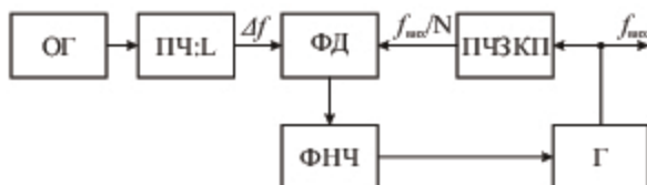
Рис. 8.6. Синтезатор частоти з подільником зі змінним коефіцієнтом поділу (ПЧЗКП), ПЧ – подільник частоти
