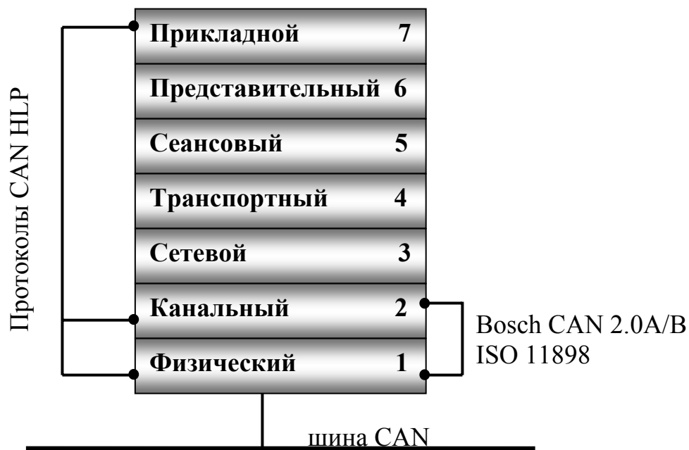
Рис.2.5. Соотношение эталонной модели OSI/ISO и CAN-протоколов [13]
