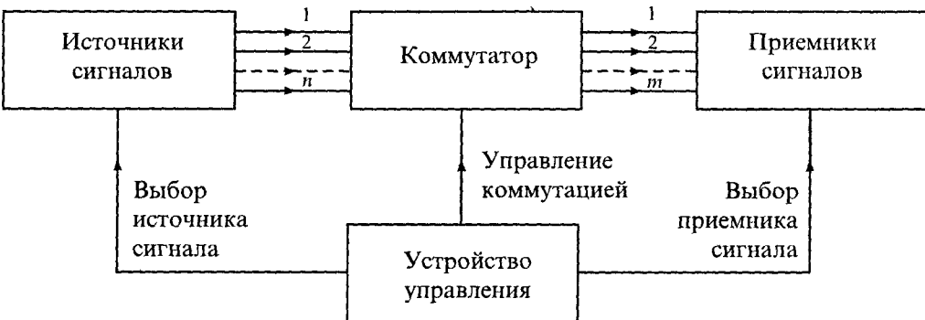
Рис. 11.1. Структурная схема коммутации источников и приемников сигналов
