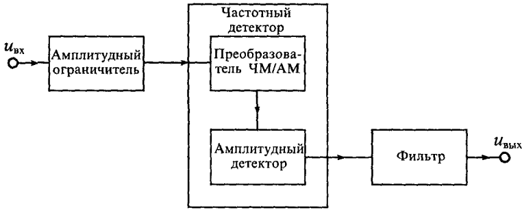
Рис. 25.7. Структурная схема частотного демодулятора
