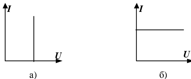
Рис. 1.5. Вольтамперні характеристики джерела ЕРС (а) і джерела струму (б)
