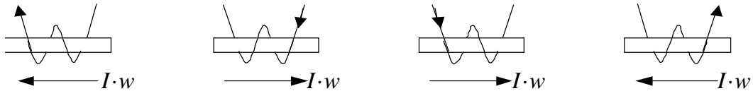
Рис. 4.4. Різні напрямки намотування котушок на сердечник і відповідний до них напрямок дії МРС
