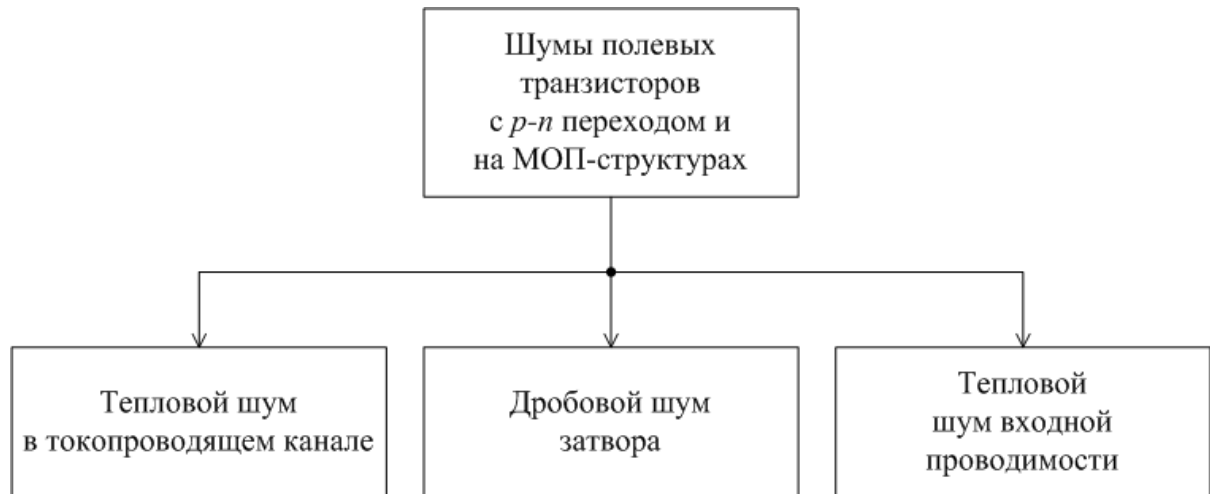
Рис. 2.7. Причины появления шумов в полевых транзисторах
