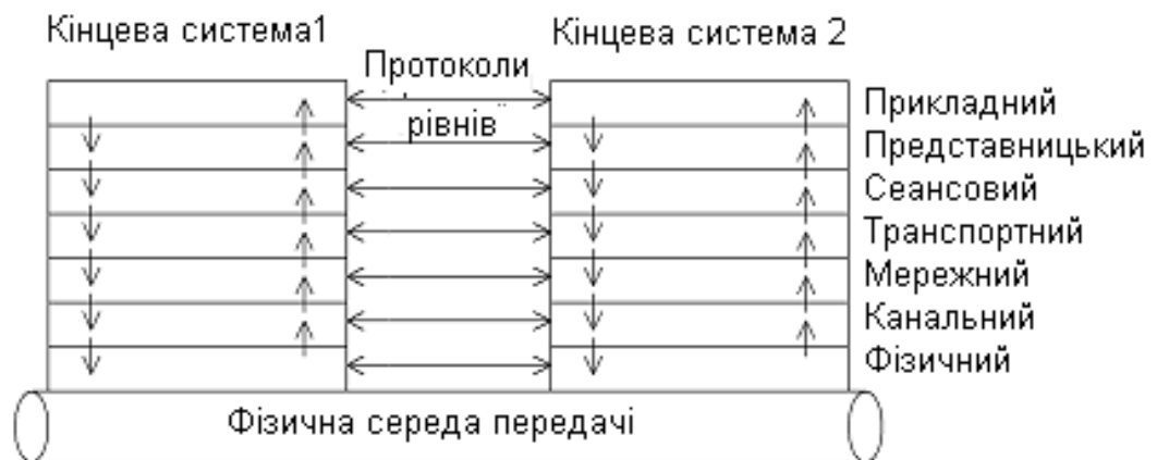
Рисунок 1.2 – Структура моделі OSI
