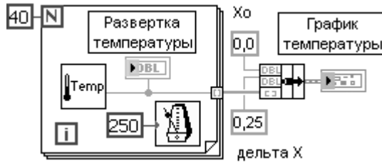
Рис. 1.17. Блок-диаграмма ВП контроля температуры с индикаторами Развертка температуры и График температуры
