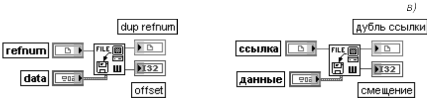
Рис. 2.36. Варианты подключения функции Записать файл (Write File)
