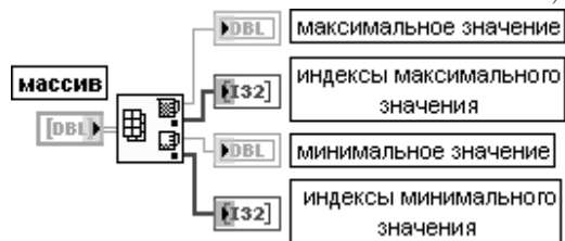
Рис. 2.25. Варианты подключения функции Максимум и минимум массива
