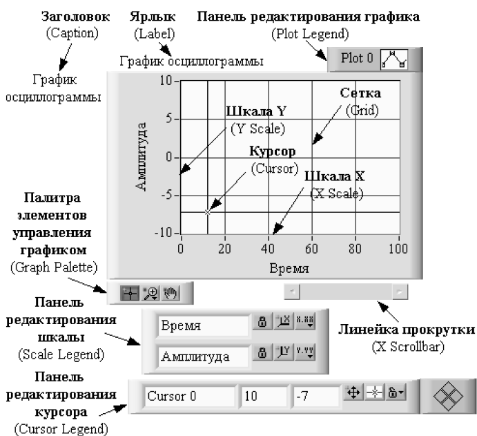
Рис. 1.19. Вид графика осциллограммы с панелями и атрибутами
