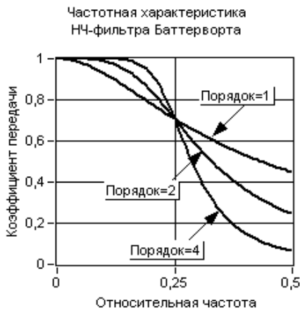
Рис. 3.19. Амплитудно-частотная характеристика фильтра Баттерворта
