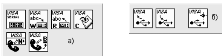
Рис. 5.39. Вид палитры функций последовательной коммуникации (а) и функций управления передачей по каналу USB (б)
