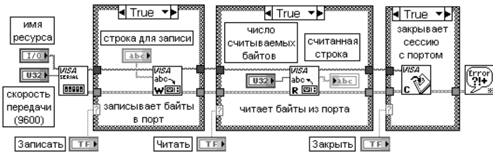
Рис. 5.40. Блок-диаграмма модернизированного ВП LabVIEW ↔ Serial
