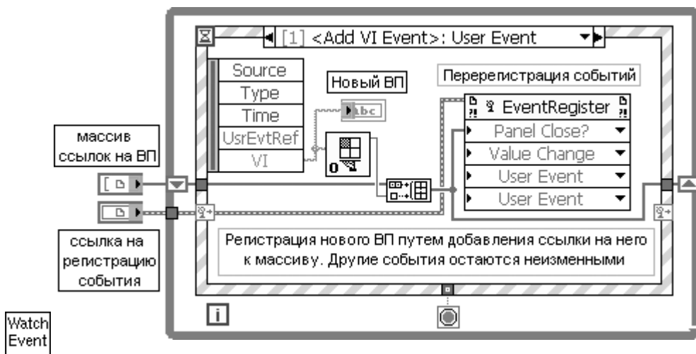
Рис. 4.14. Иконка и блок-диаграмма модернизированного подприбора Ожидать событий
