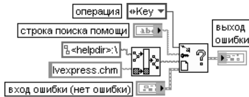
Рис. 2.61. Блок-диаграмма фрагмента Экспресс-ВП, использующего функцию Управление оперативной помощью
