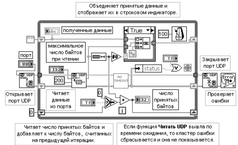
Рис. 6.17. Блок-диаграмма ВП Получатель UDP (UDP Receiver)
