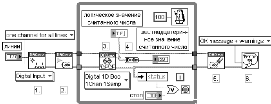
Рис. 8.17. Блок-диаграмма ВП Считать цифровой канал (Read Dig Chan)
