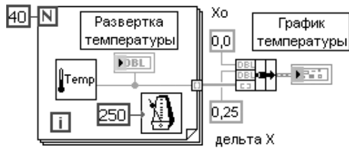
Рис. 1.28. Блок-диаграмма ВП контроля температуры с индикаторами Развертка температуры и График температуры
