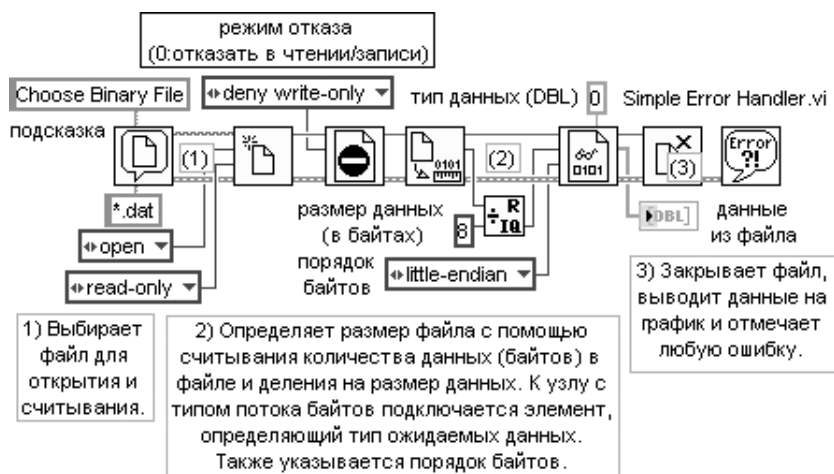
Рис. 2.41. Блок-диаграмма ВП Считать двоичный файл (Read Binary File)
