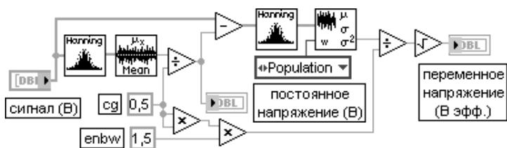
Рис. 4.11. Блок-диаграмма ВП Оценка переменного и постоянного напряжения сигнала (AC & DC Estimator)
