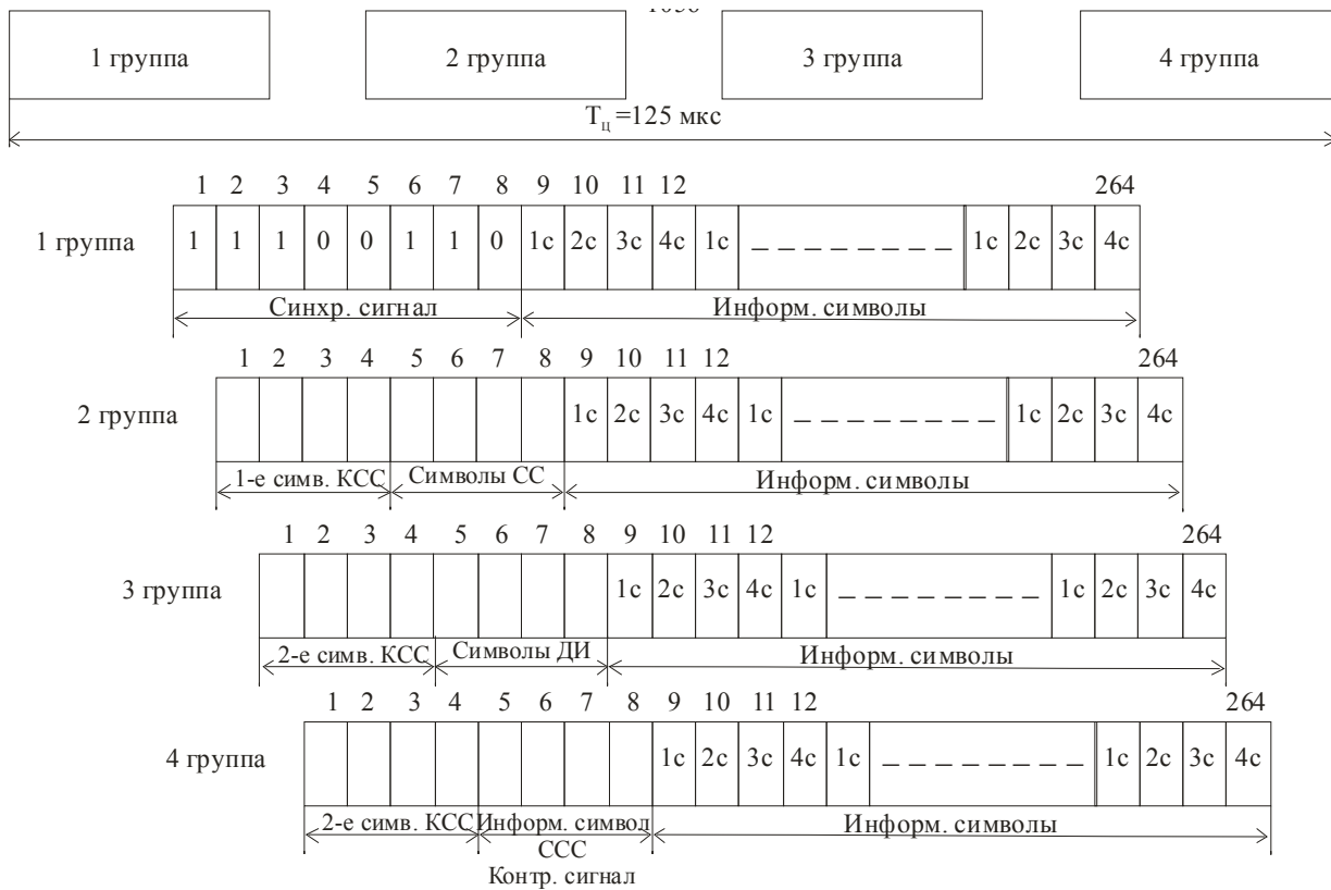
Рисунок 6.1 – Построение временного цикла вторичного цифрового потока
