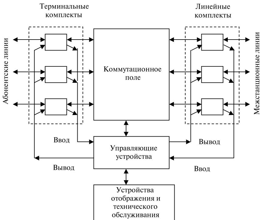
**Рис. 1.1.** Общий вид станции, предназначенной для коммутации и обработки информации
