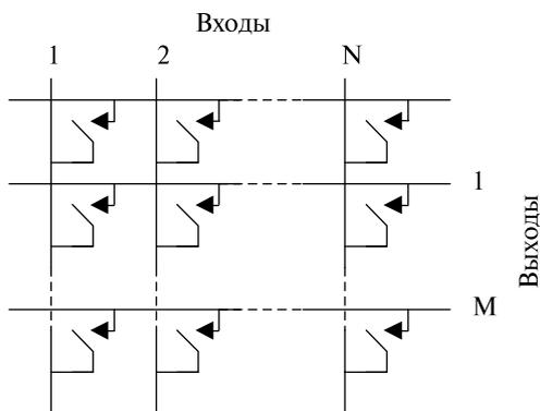
**Рис. 1.2.** Принцип построения однозвенной полностью доступной матрицы.
