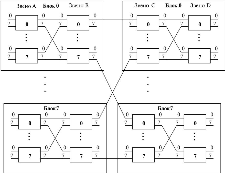
**Рис. 1.4.** Пример построения 4-звенной коммутационной схемы 512x512
