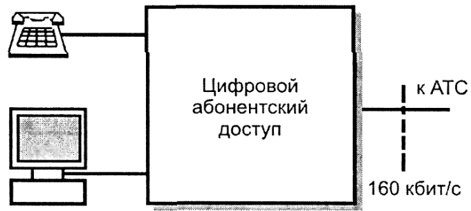
Рис. 10.27. Схема подключения абонентов при базовом доступе
