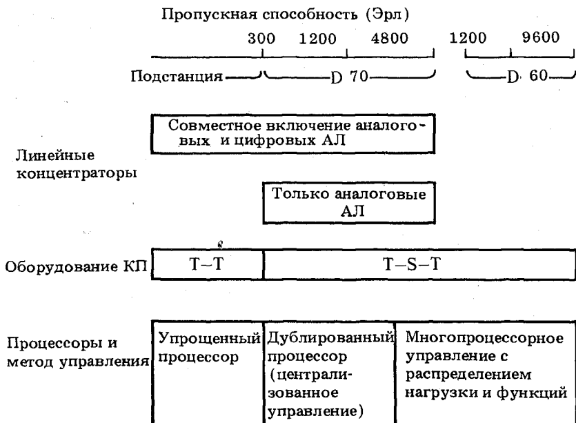
Рис. 5.11. Концепция оборудования и управления D 60 и D 70
